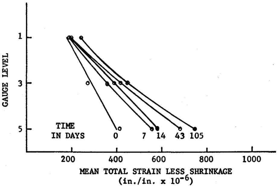
FIG 12 - CONCRETE STRAIN DISTRIBUTION, BEAM 1, CENTER LINE
