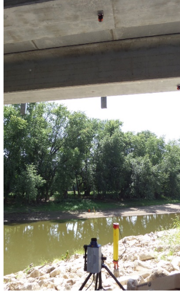
Fig. 5. Remote sensing vibrometer (RSV-150)
