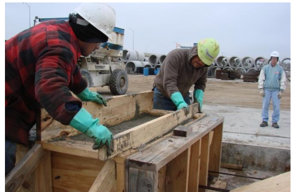
(d) Finishing of specimens
