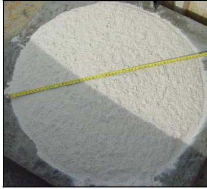
Photo 2 – DIN cone slump flow
