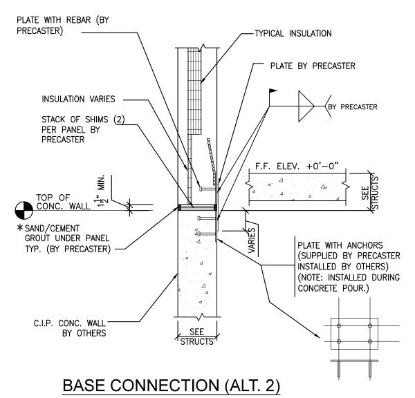
FOR SITUATIONS WHERE THE FOUNDATION WALL IS EQUAL TO THE PRECAST WALL
