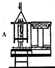
(d) Position precast diagonals in half segment A
