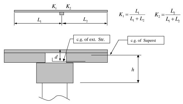
Fig. 4 Extended Strand Design parameters
